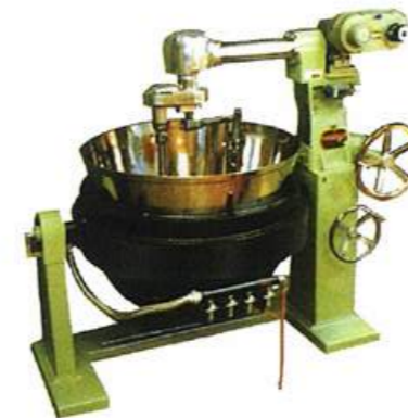
(1) 直火釜転倒式 (ガスボイル)
